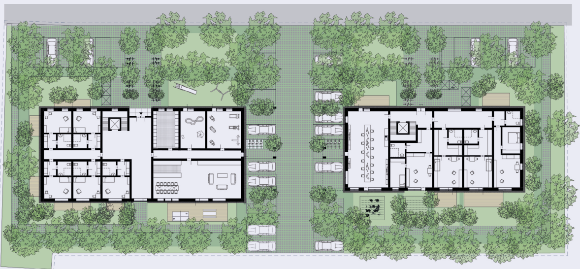
Abbildung 14: Die Vorzone der Wohngebäude muss oft verschiedenen Erschließungsfunktionen gerecht werden. In dieser gemeinschaftlichen Wohnanlage (Fallbeispiel 3) dient sie zusätzlich als barrierefreier Aufenthalts- und Kontaktraum mit der Umgebung. Parken zwischen den Häusern ermöglicht zudem einen direkten Zugang in die Gebäude. Quelle: Stefanie Ophelders und Karolína Šimonová, 2022 (RWTH Aachen).
