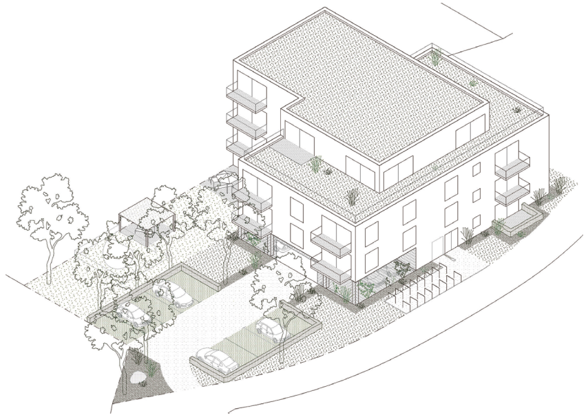
Abbildung 3: Klare Verortung von Funktionsflächen zwischen Straßenraum und Gebäude ermöglicht eine günstige Verteilung einzelner Nutzungen auch auf engen Grundstücken. Erholungsflächen liegen geschützt und mit einer direkten Verbindung zum Wohngebäude. Quelle: Katharina Schwermer, Rani Gerges, Moritz Mennenöh, 2022 (RWTH Aachen).
